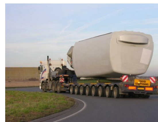
Transport de la nacelle
